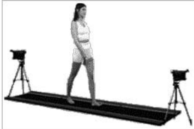
Figura 23: pedana baropodometrica per l'analisi del passo e sistema di visione.
